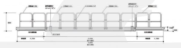
※注意 テスリは組立後取り付けている連結バンドで必ず固定してください。
