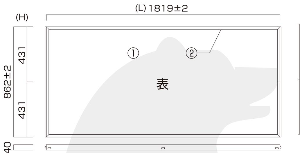
①アルミ樹脂積層複合材 ②アルミフレーム
