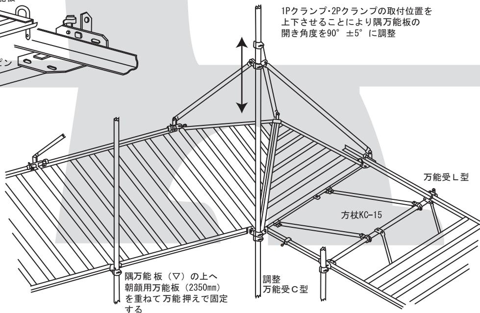
調整万能C受使用空間は方杖「KC-15」2本を取り付けて振れ止めの働きをさせる。
